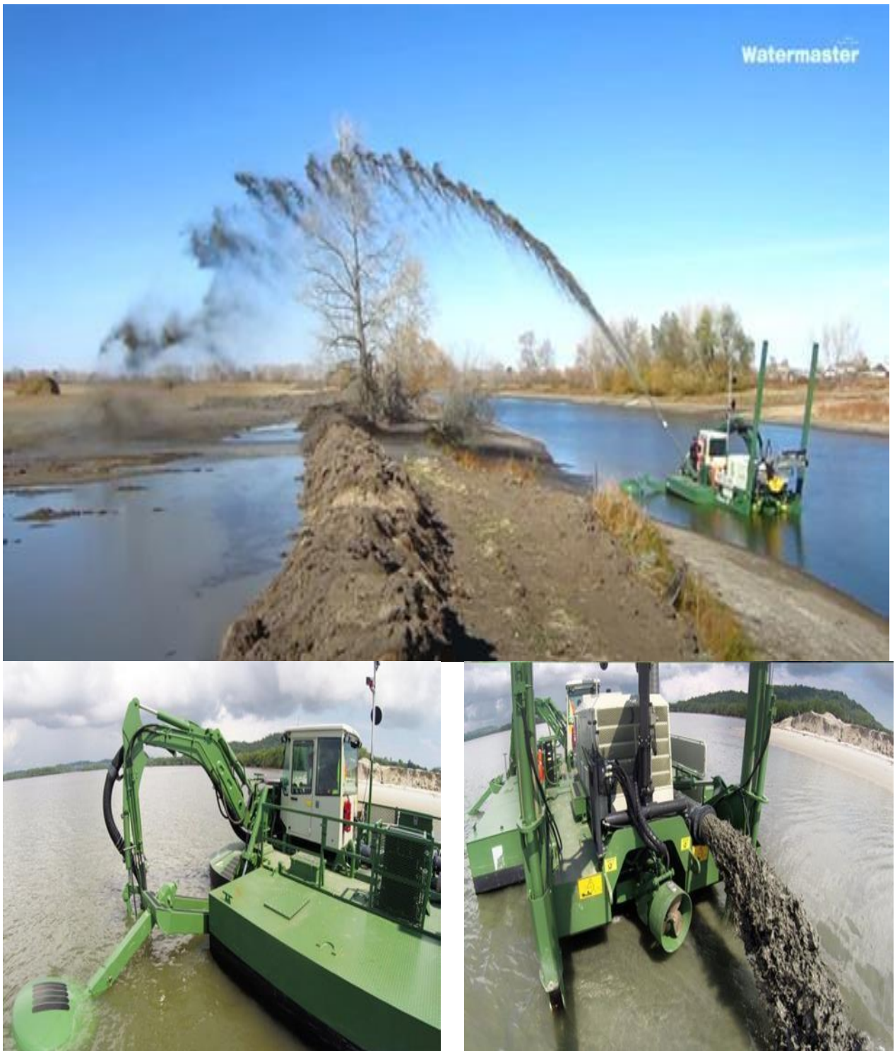
Рисунок 3.4 Работа Земснаряда Амфибия – Ватермастер
