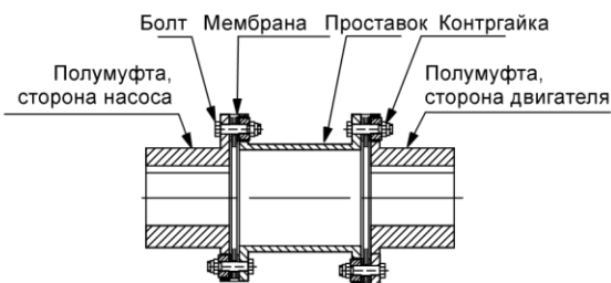
Конструкция упругой пластинчатой муфты
