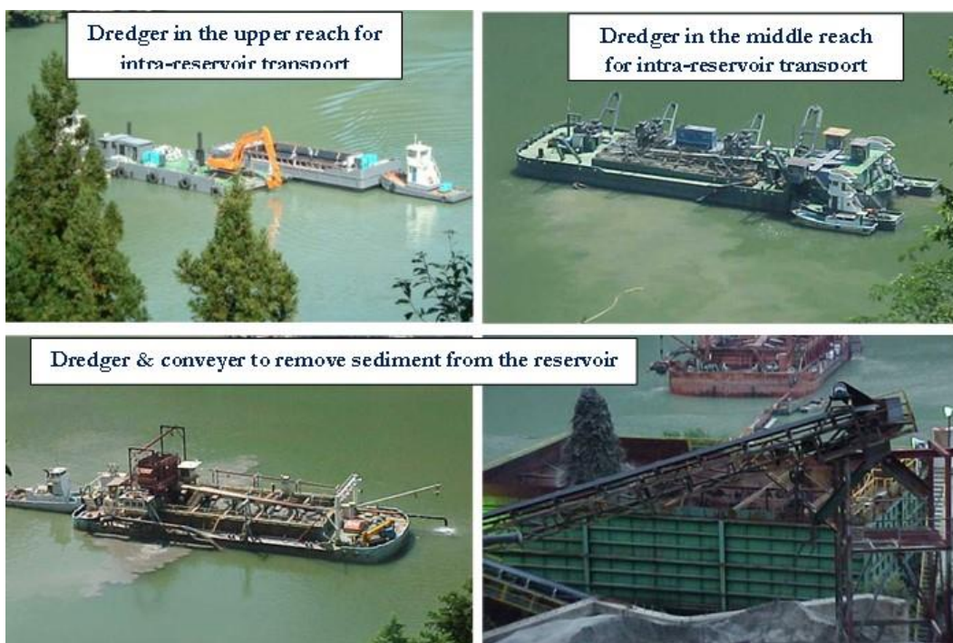
Рисунок 5-8 Механизм дноуглубления и удаления наносов (предоставлено J-Power)
