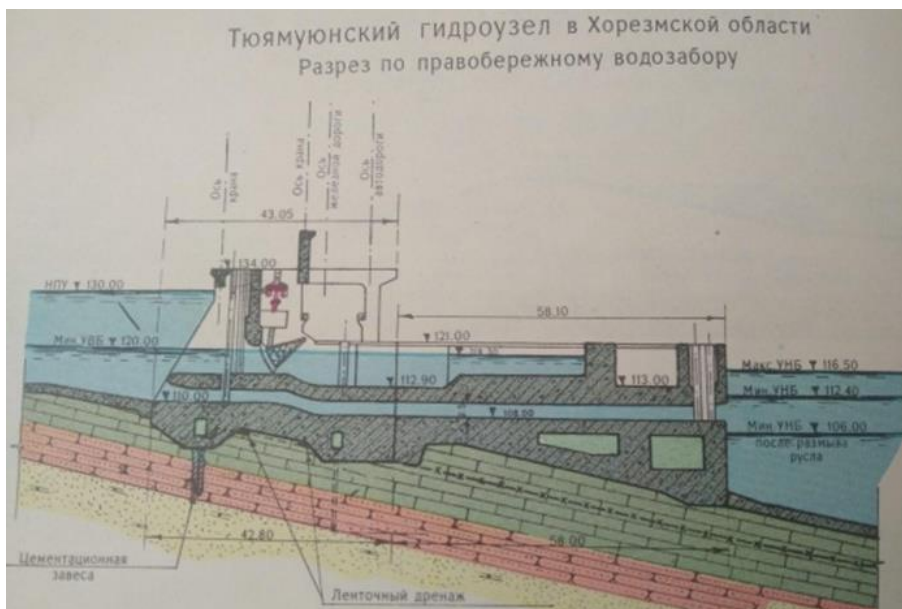
Рисунок 2-9 Разрез по правобережному каналу
