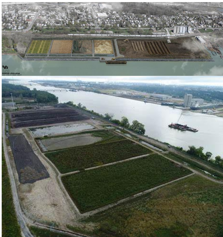
Рисунок 3-30 Различные отсеки для размещения удаленных наносов
