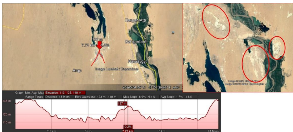
Рисунок 3-8 Профили русла вдоль некоторых понижений (на основе Google Earth), которые можно использовать для внерусловых водохранилищ.
