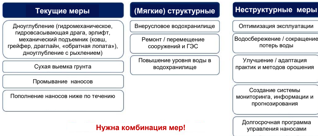
Рисунок 3-1 Возможные меры для решения проблем заиления ТМГУ
