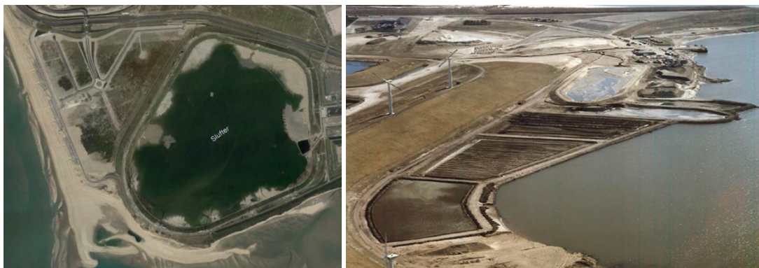
Рисунок 3-31 Вид сверху на Слафтер (изображение GE слева) и осадочный бассейн и площадки производства глины (изображение справа - Plans Working Group Envicom 5)
