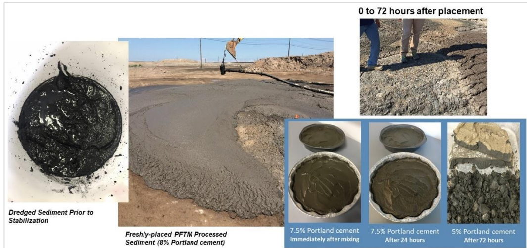
Рисунок 3-25 Переработанные наносы с использованием PFTM
