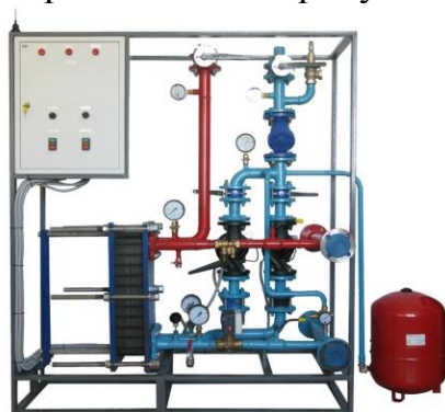
Рисунок 4 – Автоматизированный тепловой пункт для присоединения системы отопления по независимой схеме
