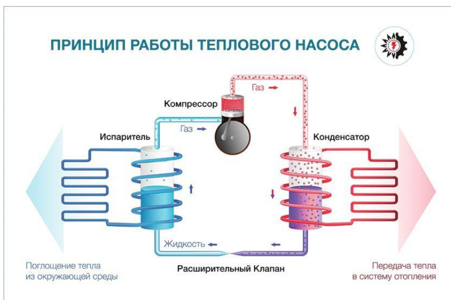
Рисунок 2 – Схематический принцип работы теплового насоса
