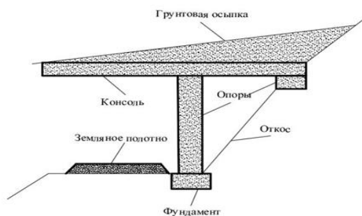
Рисунок 3. — Консольная галерея с центральной опорой
