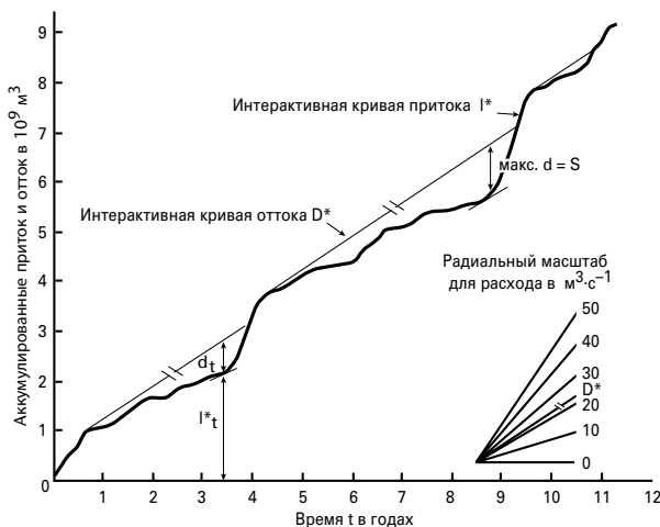
Рисунок II.4.4. Метод массовой кривой для определения емкости водохранилища
