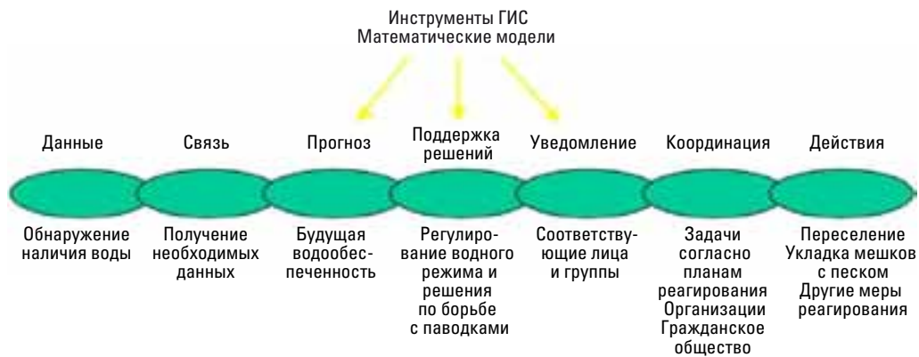
Рисунок II.7.1. Интегрированная система прогнозирования паводков, предупреждения и реагирования при комплексном управлении водными ресурсами: критическая цепь событий и действий
