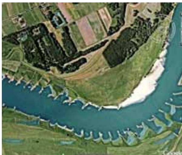
Рисунок II.4.35. Система волнорезов на 477-м км реки Эльба. Гравийные насыпи с внутренней стороны не затрудняют навигацию.
