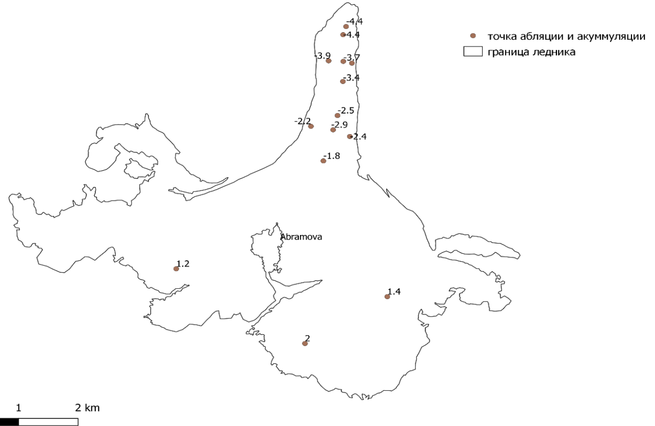
Карта-схема ледника Абрамова с расположением абляционных реек, мест шурфования и изолиниями баланса массы
