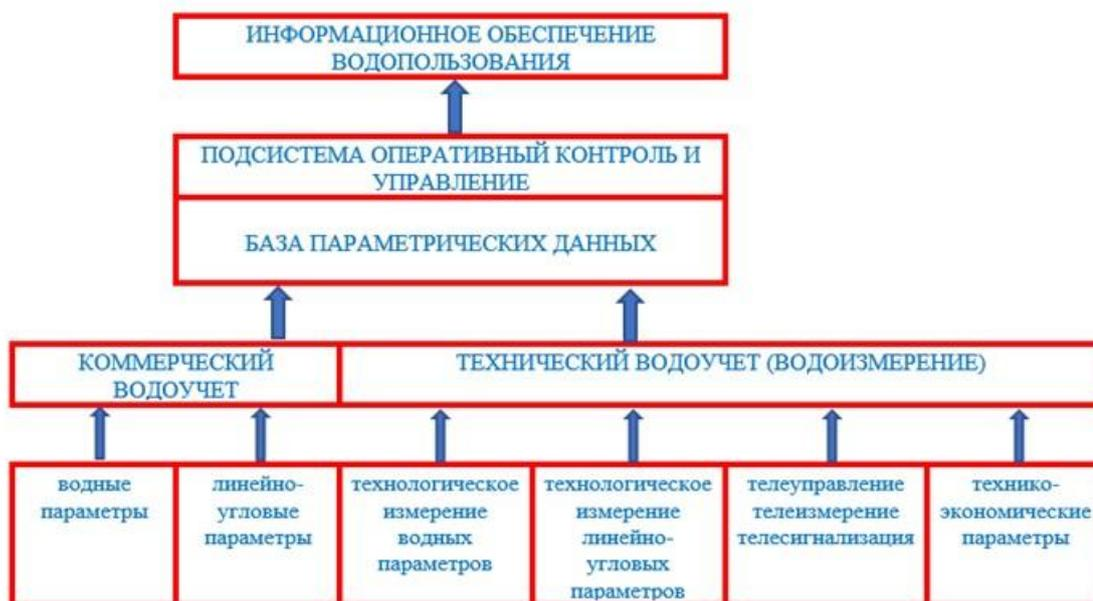
Рисунок 2 – Структурная схема дерева целей, достигаемых комплексом «водоучет – водоизмерение» в составе системы информационного обеспечения водопользованием\*
