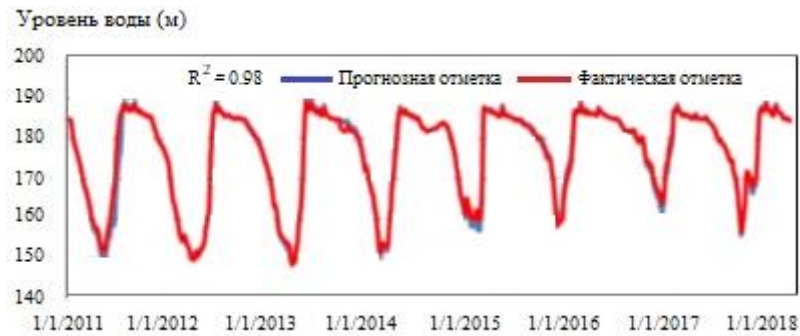
Рис. 10. Сравнение фактического и расчётного уровня воды в водохранилище (Hlaing и соавторы, 2019)
