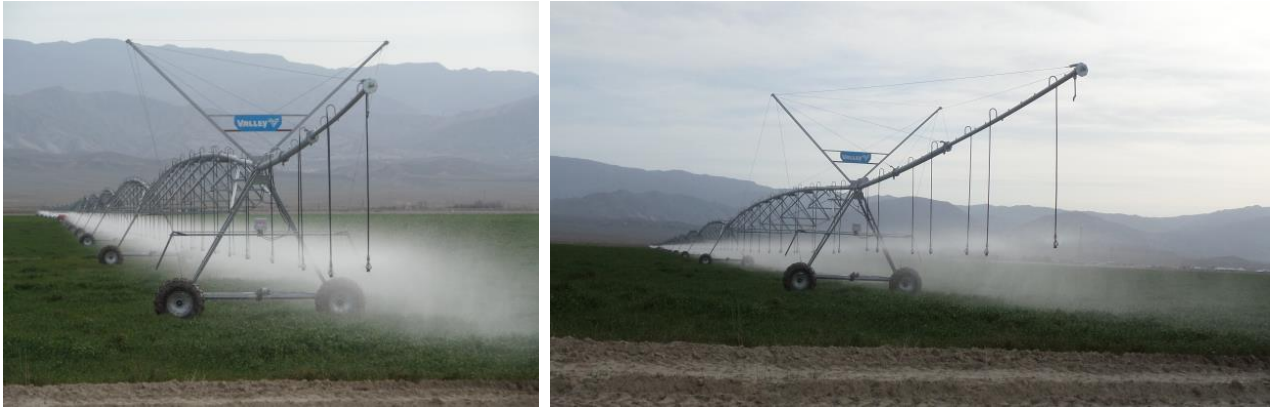
3-nji surat. Baharly etrabynyň Ş.Batyrow adyndaky daýhan birleşiginde frontal hereketde işleýän “VALLEY” kysymly giň gerimli emeli ýaguş ýagdyryjy enjamy bilen bugdaýyň suwarylyşy
