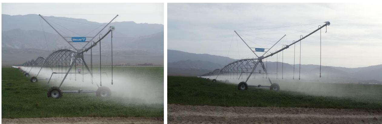
Рис. 3. Полив пшеницы широкозахватной стационарной дождевательной машиной фронтального действия “VALLEY”, установленная на землях дамханского объединения им. Ш.Батырова Бахарлинского этрапа Ахалского веляята
